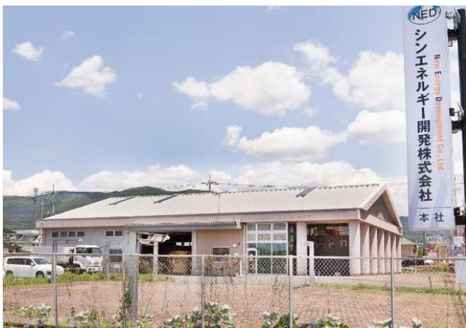
一見ふつうの社屋だが災害停電時にはガス化CHPが熱エネルギーを供給するオフグリッドシステム防災拠点に変身する(NED沼田本社)
